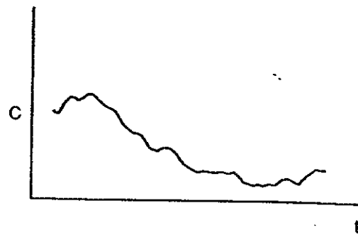
(d) Pollutograph with first flush
